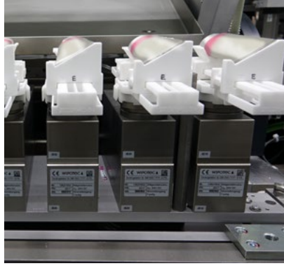
Wägezellen-Integration zur Reduzierung des Give-away
