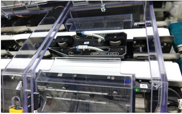
Doppelspur-Mulden-Band zur Tubenführung
