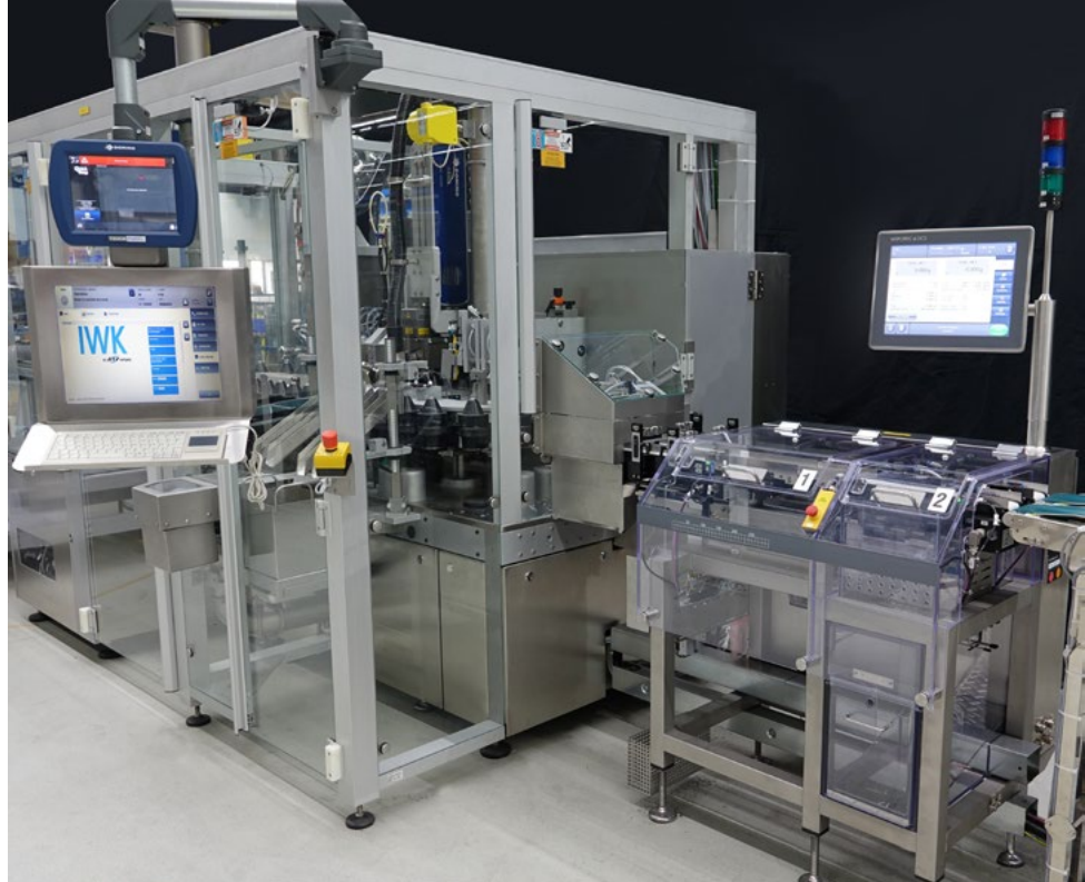
Kontrollwaagenlösung HC-A 2 Spur nach dem Tubenfüller
