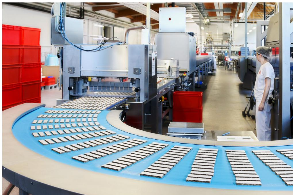
Ultraschallgeschnittene Oblaten, hier noch im Schritttempo unterwegs. Später im Einspurbetrieb steigt die Geschwindigkeit um mehr als das Zehnfache an.
