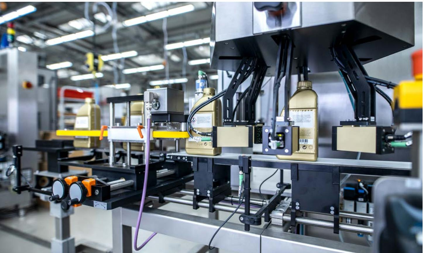
Rundum-Überprüfung von Labels und Codes
