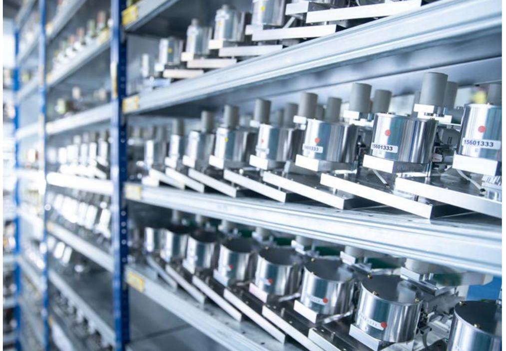
Das Herzstück der Produktion bei WIPOTEC: Wägezellen für verschiedene Branchen
