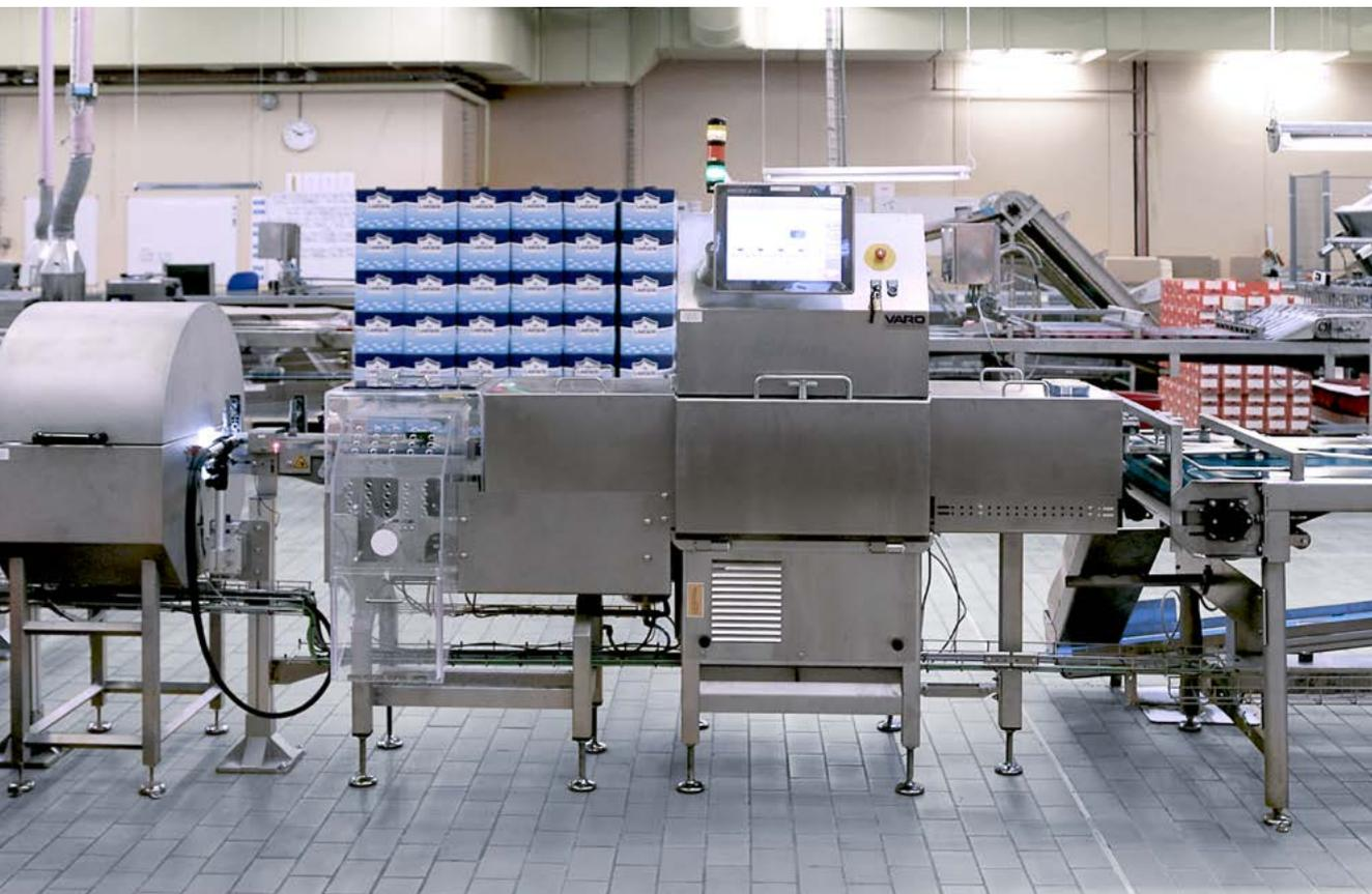
Eingedoste Makrelen: Produktionslinie mit integriertem Röntgeninspektionssystem
