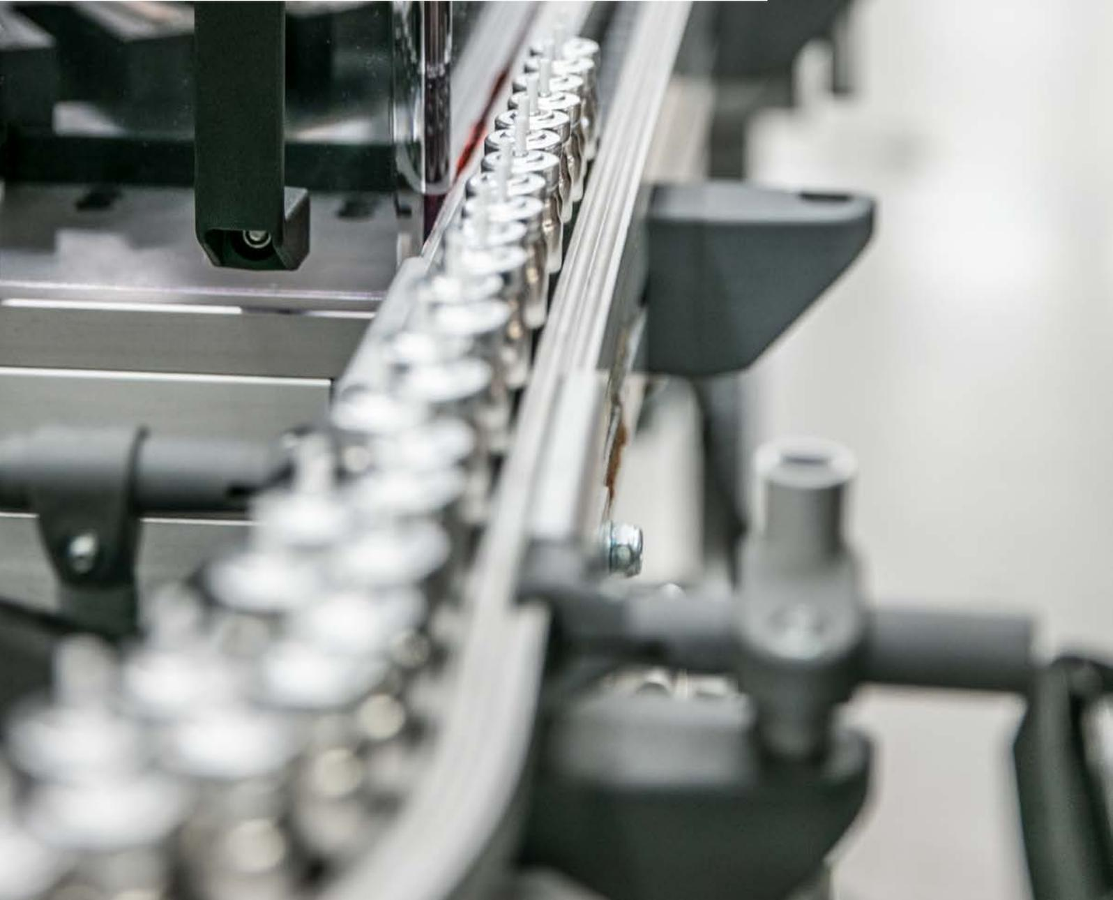
HC-A-IS Kontrollwaage von WIPOTEC-OCS im Einsatz in der Produktion bei Zellaerosol
